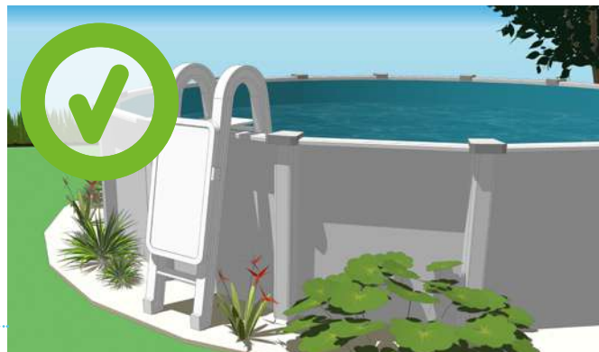
Exemple d'échelle munie d'une portière de sécurité.
